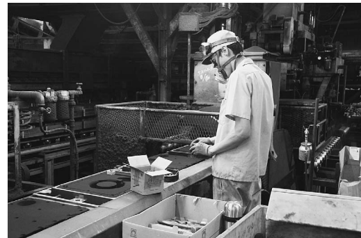
自動造型機は連続し鑄型を交換
