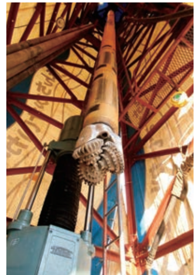
ボーリングタワー内部 鉄骨のやぐらにボーリングビットが吊るされ真っ直ぐ掘削する
