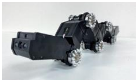
「配管くんⅠ型」直径100mm～150mmの配管に対応。水平だけでなく垂直の配管内の走行も可能
