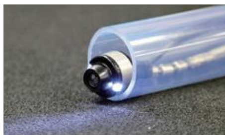
「配管くんⅡ型」直径40mm～125mmの配管に対応。高圧洗浄機の先端に取り付け、水の勢いで配管内を移動
