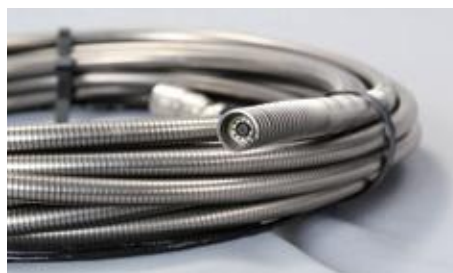
「配管くんⅢ型」直径20mm～50mmの配管に対応。パネワイヤーの回転と押し込みにより配管内を移動
